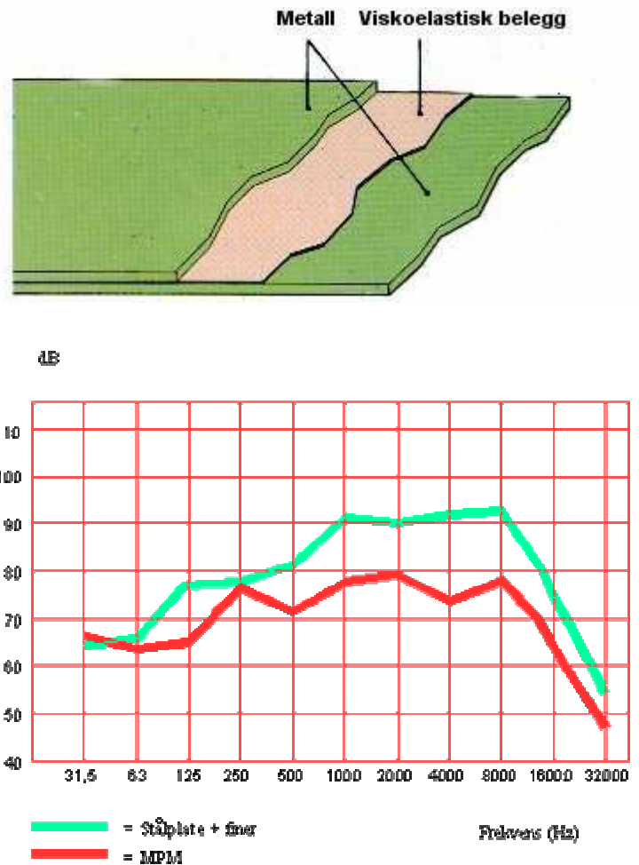
Fig. 1. Viser lydtrykksnivået ved arbeidet på en transportrenne produsert av MPM i forhold til en renne produsert av en stålplate + en finerplate. Ved bruk av MPM reduseres lydtrykksnivået med ca. 14dB.
